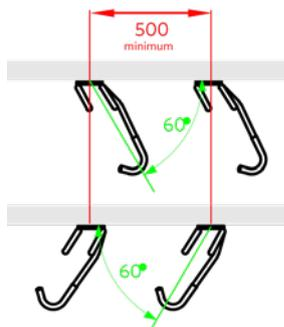
Diese Variante des Josta-Wandhalters ermöglicht das Abstellen von Fahrrädern in einem Winkel von 60 Grad zur Wand.
