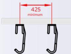
Die Standardmethode für die Montage des Josta-Wandhalters ist ein Winkel von 90 Grad zur Wand.
